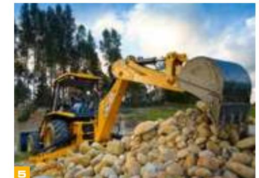
Para garantizar el mejor rendimiento en todo tipo de condiciones, la 3CX está equipada con 4WD como estándar y tiene una velocidad máxima de 40 km/h con neumáticos de 28".
